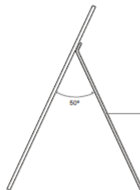
SUPORE PARA PLACA EM FERRO 3/8" FIXADO COM TACAFIXOS SISTEMA ABRE E FECHA, COM LIMITADOR DE ABERTURA
